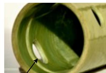
Pose d'un insert ou autres pièces annexes par collage.
