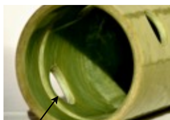
Usinage d'une gorge intérieure et pose d'une bague en inox
